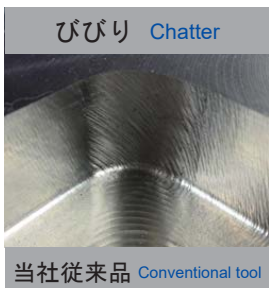
V字加工 V-shaped machining 工具突出し長さ Overhung length : 80mm 側面切削（ダウンカット）Shoulder milling, Down cut
