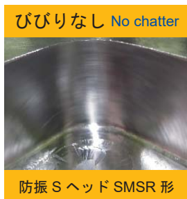
V字加工 V-shaped machining 工具突出し長さ Overhung length : 80mm 側面切削（ダウンカット）Shoulder milling, Down cut
