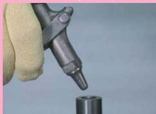
モジュラーヘッド、オール超硬シャンクアーバ『頑固一徹』(もしくはスチールシャンクアーバ『頑固G-Body』)の締結部をエアにて清掃ください。
