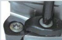
5 チップが完全に固定されたことを確認し、クランプ駒用ネジを締め込んでください。(クランプ駒は、完全に取り外さなくても、ゆるめるだけでチップの着脱は可能です。)
