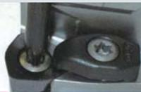
4 チップをチップ座に確実に押さえながら、固定してください。市販のトルクコントロールレンチもしくは、付属されているレンチを使用してチップクランプネジを締め込んでください。
