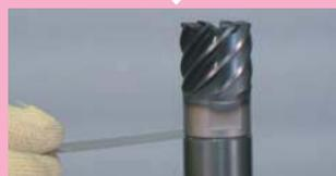
トルクコントロールスパナ、もしくはSヘッド専用スパナ(DSタイプ ※Sヘッド使用時)にて、規定トルク値でゆっくりと回転させ本締めしてください。隙間がないことを確認ください。
