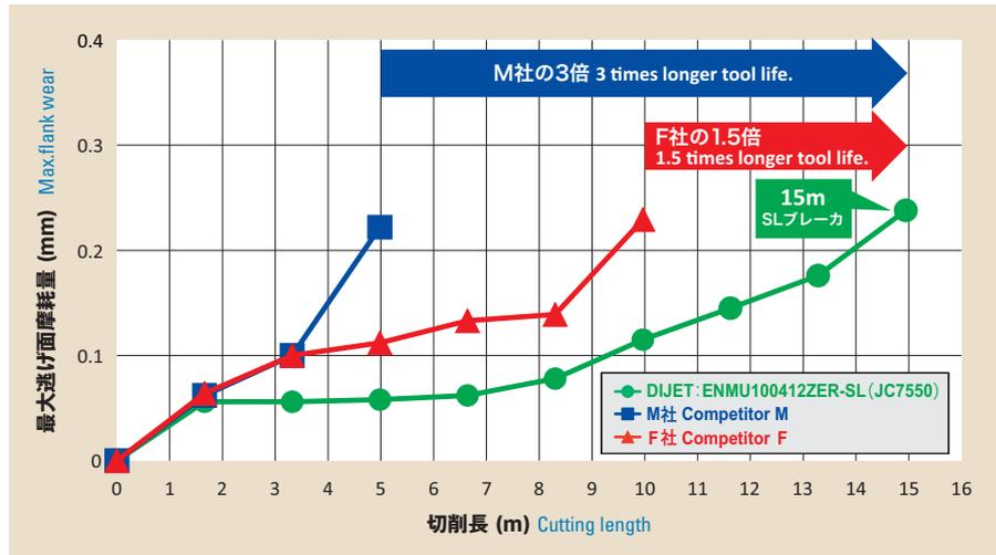
被削材 : **Ti-6Al-4V**
