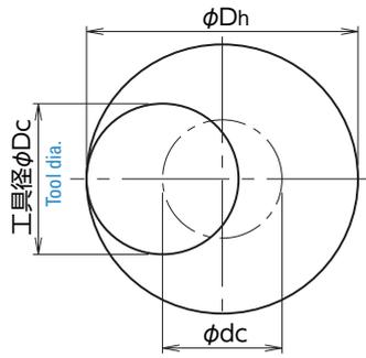
● ツールパスの算出方法 Calculation of tool pass dia.
