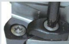
5 チップが完全に固定されたことを確認し、クランプ用ネジを締め込んでください。(クランプ用は、完全に取り外さなくても、ゆるめるだけでチップの着脱は可能です。)
