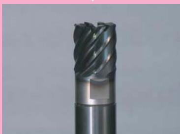
手締めにて、モジュラーヘッド端面とオール超硬シャンクアーバ『頑固一徹』(もしくはスチールシャンクアーバ『頑固G-Body』)端面が当たるまで仮締めしてください。
