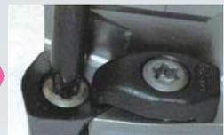
6 ⚠ 必ず再度チップクランプネジを締め込んで、チップを完全に固定してください。
