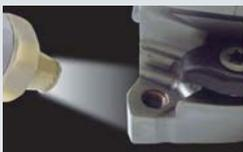
1 チップを取り付ける前に、チップ座をハケやエアブローで清掃し、切りくず等を除去してください。その際、チップ座の変形およびバリ等がないかチェックしてください。
